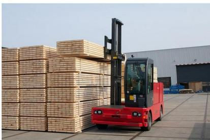
Zudem wurde die Kabine ergonomisch optimiert. So besitzt die Standardkabine eine breite von 800 mm und ist komplett geschlossen. Durch das Dachfenster haben Sie jederzeit eine gute Sicht auf die Ladung. Zudem bietet die schlankgestaltete Lenksäule eine optimale Sicht nach vorne.
